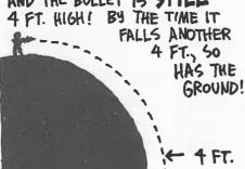
THE BULLET IS NOW IN A 4-FOOT-HIGH ORBIT AROUND THE MOON. IT IS FALLING CONTINUALLY, BUT THE GROUND IS STEADILY CURVING AWAY BENEATH IT.
